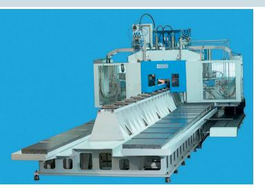
2 Eine vollautomatische Anlage zum Zerspanen unterschiedlicher Profile mit bis zu 8 m Länge. Was die Dimensionierung der Anlagen betrifft, ist laut SSB-Maschinenbau lediglich die Größe der jeweiligen Kunden-Werkhalle das Limit
